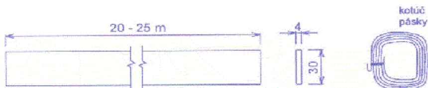
Obr.č.2: – Uzemňovacia páska 30 x 4 mm
