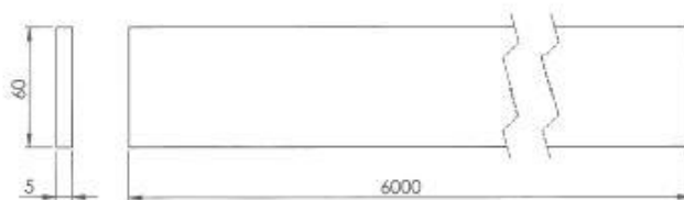
Obr.č.6: – Uzemňovacia páska 60 x 5 mm
